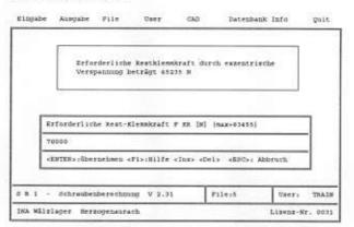
Außer der erforderlichen Restklemmkraft bei Querkraft (Reibung) wird jetzt auch die erforderliche Restklemmkraft bei exzentrischer Last (Abheben) angezeigt. Die maximal mögliche Restklemmkraft für FMmax = FM ohne zusätzliche Beanspruchung erscheint im Eingabefenster.
