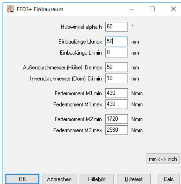
Ähnlich wie in FED1+ kann man jetzt auch in FED3+ einen Einbauraum eingeben und dafür Federn mit unterschiedlichem Drahtdurchmesser, Windungsdurchmesser und Windungszahl berechnen lassen. Von den berechneten Varianten kann man dann die für die jeweilige Anwendung optimale Drehfeder wählen (größte Sicherheit, geringstes Gewicht, kleinste Länge, größte Eigenfrequenz, kleinste Toleranz nach DIN 2194).
