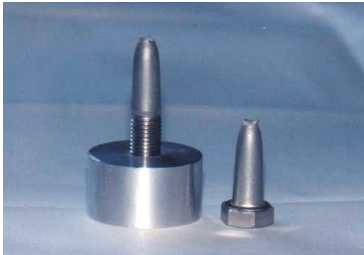
Bild 7.3: Austenitischer Bolzen A2-70, M 16 mit Aluminiummutter aus 3.0615.71 (F 28), Einschraubtiefe m = 21 mm, Längung: 25 mm, Bruchkraft F = 128 kN
