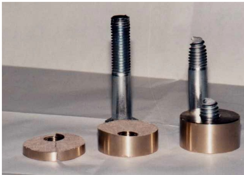
Bild 7.5: Kugelformig geplatzte Mutter PAN 16 mit Bolzen aus 5.6 Links: Einschraubtiefe: m = 17 mm, Abstreifkraft F = 135,6 kN Rechts: Einschraubtiefe: m = 19 mm, Bruchkraft F = 135,8 kN
