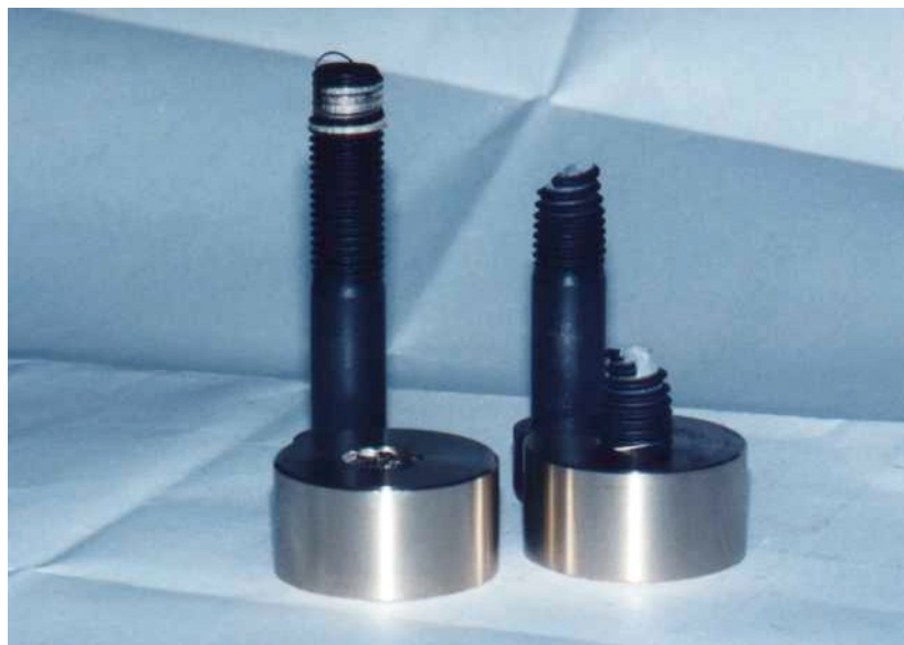
Bild 7.1: Abgestreiftes Gewinde und gebrochener Bolzen
